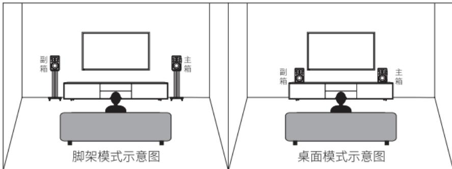
**对于脚架模式音箱的摆放：**音箱放在专用的音箱脚架上面，将音箱后板的拨档开关(拨置脚架模式STAND)将获得平直的曲线。
