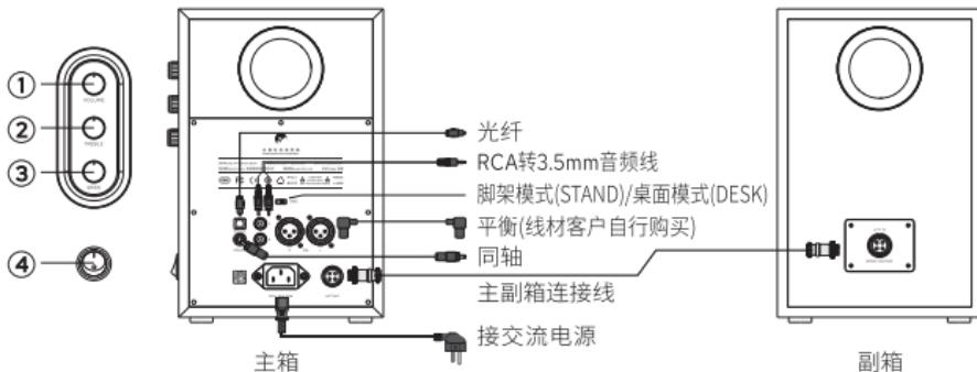
① 向下按为输入信号通道选择，不同的指示灯颜色代表不同的输入模式。
