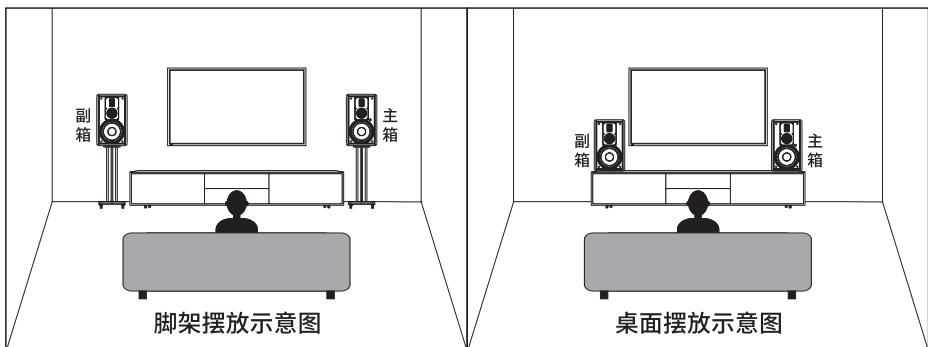
音箱最理想的位置是放置于电视两侧，您也可以购买专用的音箱支架来使用，将音箱放置于支架上，建议音箱与地面的高度保持在60-100cm左右，一般以音箱的高音扬声器与聆听者坐下来听音时耳朵的高度基本一致即可。音箱背面和侧面距墙建议保持不少于30cm的距离，两个音箱之间的距离要在70cm以上。如果您离电视较远，可适当拉开两个音箱的距离。听音者与音箱之间的垂直距离一般在50-100cm之间，听音者尽可能地位于两音箱的中心位置，通过仔细调整摆放距离、角度以期获得满意的立体声效果，重现音乐的声场和空间感。此方面的问题可向本音箱的销售商咨询。
