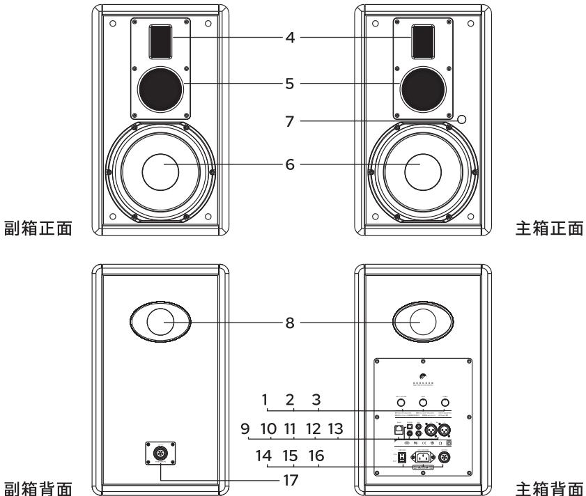
1. 向下按为输入信号通道选择，不同的指示灯颜色代表不同的输入模式。
