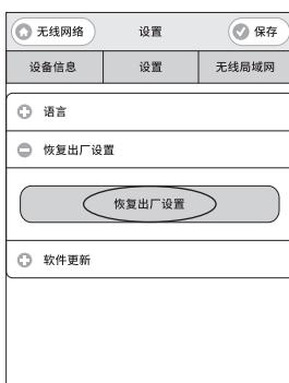
(5) 点击“恢复出厂设置”，听到提示音后，重启成功。或者长按5秒遥控器上的静音键，音箱指示灯红色闪耀两次，听到提示音后，重启成功。
