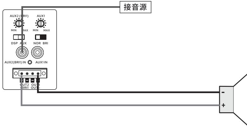
**！ 注意！连接桥接模式的输出时请确保极性的正确！**
